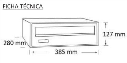
Fabricado totalmente en aluminio, con garantía anti-corrosión.
